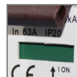
kontrolka sygnalizująca zadziałanie
