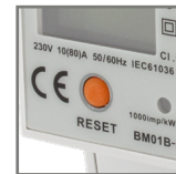
BM01B-L przycisk RESET do kasowania podlicznika
